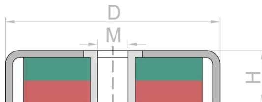
Scherkraft: Die angegebene Haftkraft wurde rechtwinklig zum Haftgrund gemessen. Um den Magneten seitlich zu verschieben, ist eine viel kleinere Kraft notwendig. Wenn Sie einen Topfmagneten also an einer Wand verwenden, können Sie ihn deutlich weniger belasten, als wenn Sie ihn an der Decke einsetzen.
